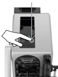
Fig. 9-D - premere il pulsante di erogazione del latte: il LED lampeggerà durante il riscaldamento e rimarrà fisso a temperatura raggiunta
